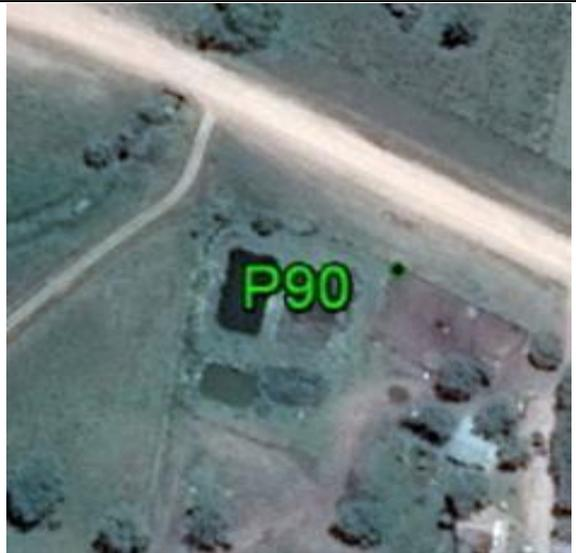
**Fecha: 28/01/2017****Modo de Levantamiento: Estático****Tipo/Modelo de antena utilizado: Trimble R6-4 Internal / AR20 w/LEIM Dome****Altura / Tipo de Medición de la antena: 2,000m / Base del montaje****Nombre de archivo Rinex: P90\_0285****Observaciones: Punto recogido en la esquina de la cerca. Todas las unidades están en metros a menos que se indique lo contrario.****Ejecutado por:****Topocart - Topografía, Engenharia e Aerolevantamento S/S Ltda**
