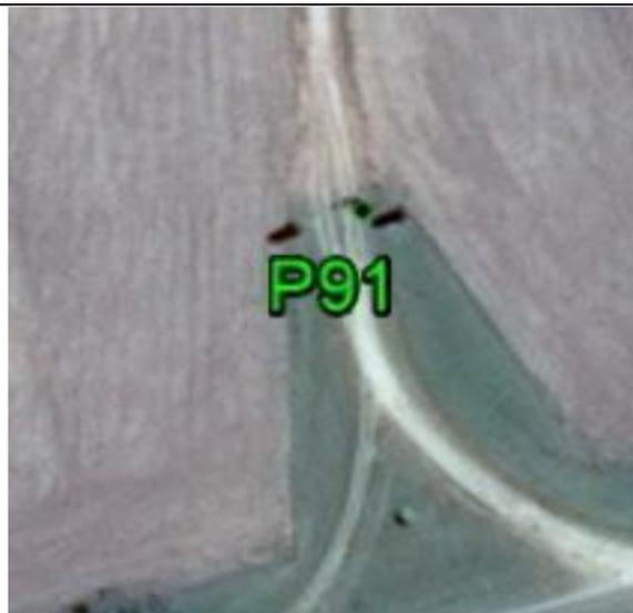
**Fecha: 14/02/2017****Modo de Levantamiento: RTK****Tipo/Modelo de antena utilizado: Trimble R6-4 Internal / AR20 w/LEIM Dome****Altura / Tipo de Medición de la antena: 2,000m / Base del montaje****Nombre de archivo Rinex: -****Observaciones: Punto recogido en la esquina de la pared. Todas las unidades están en metros.****Ejecutado por:****Topocart - Topografía, Engenharia e Aerolevanteamento S/S Ltda**
