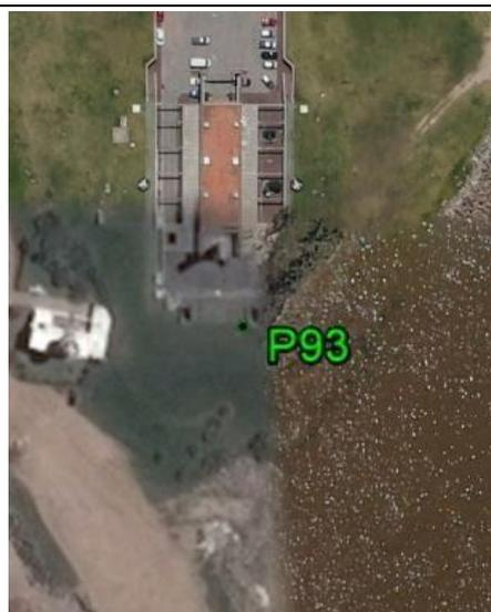
**Fecha: 28/01/2017****Modo de Levantamiento: Estático****Tipo/Modelo de antena utilizado: Trimble R6-4 Internal / AR20 w/LEIM Dome****Altura / Tipo de Medición de la antena: 2,000m / Base del montaje****Nombre de archivo Rinex: P93\_0286****Observaciones: Punto recogido en la esquina de la pared. Todas las unidades están en metros.****Ejecutado por:****Topocart - Topografía, Engenharia e Aerolevantamento S/S Ltda**
