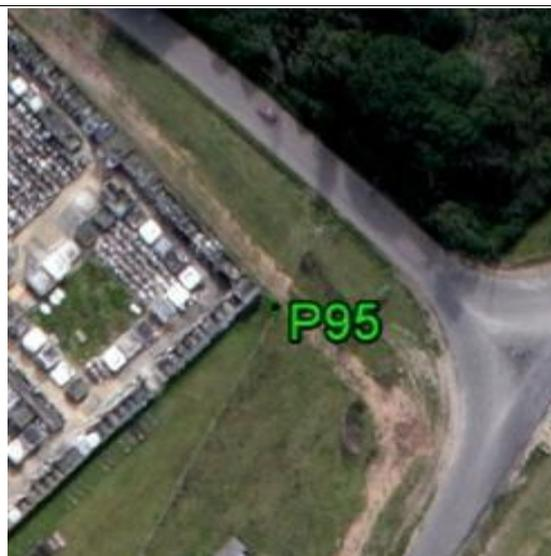
**Fecha: 07/02/2017****Modo de Levantamiento: RTK****Tipo / Modelo de antena utilizado: Trimble R6-4 Internal / AR20 w/LEIM Dome****Altura / Tipo de Medición de la antena: 2,000m / Base del montaje****Nombre de archivo Rinex: -****Observaciones: Punto recogido en la esquina de la pared. Todas las unidades están en metros.****Ejecutado por:****Topocart - Topografía, Engenharia e Aerolevantamento S/S Ltda.**
