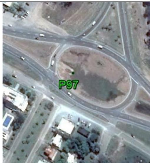
**Fecha: 07/02/2017****Modo de Levantamiento: RTK****Tipo / Modelo de antena utilizado: Trimble R6-4 Internal / AR20 w/LEIM Dome****Altura / Tipo de Medición de la antena: 2,000m / Base del montaje****Nombre de archivo Rinex: -****Observaciones: Punto recogido en la esquina de la galería. Todas las unidades están en metros.****Ejecutado por:****Topocart - Topografía, Engenharia e Aerolevantamento S/S Ltda.**
