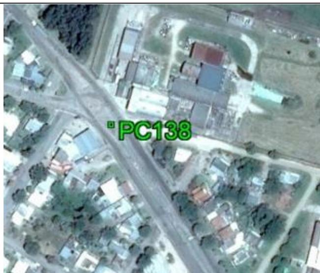
**Fecha: 23/02/2017****Modo de Levantamiento: RTK****Tipo / Modelo de antena utilizado: Trimble/ R6-4 Internal****Altura / Tipo de Medición de la antena: 2,000 / Base del montaje****Nombre de archivo Rinex: -****Observaciones: Punto recogido en la esquina de la calzada. Todas las unidades están en metros.****Ejecutado por:****Topocart - Topografía, Engenharia e Aerolevanteamento S/S Ltda.**
