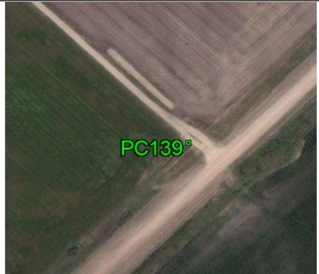
**Fecha: 23/02/2017****Modo de Levantamiento: RTK****Tipo / Modelo de antena utilizado: Trimble/ R6-4 Internal****Altura / Tipo de Medición de la antena: 2,000 / Base del montaje****Nombre de archivo Rinex: -****Observaciones: Punto recogido en la esquina de la cerca. Todas las unidades están en metros.****Ejecutado por:****Topocart - Topografía, Engenharia e Aerolevantamento S/S Ltda.**
