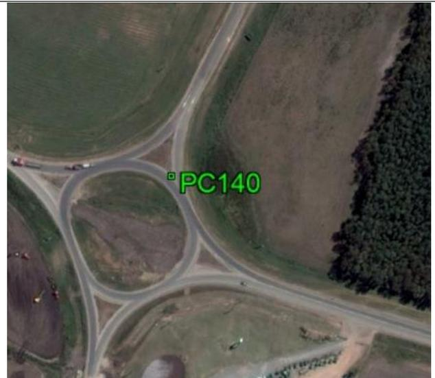
**Fecha: 23/02/2017****Modo de Levantamiento: RTK****Tipo / Modelo de antena utilizado: Trimble/ R6-4 Internal****Altura / Tipo de Medición de la antena: 2,000 / Base del montaje****Nombre de archivo Rinex: -****Observaciones: Punto tomado en el canto de la calzada. Todas las unidades están en metros.****Ejecutado por:****Topocart - Topografía, Engenharia e Aerolevantamento S/S Ltda.**
