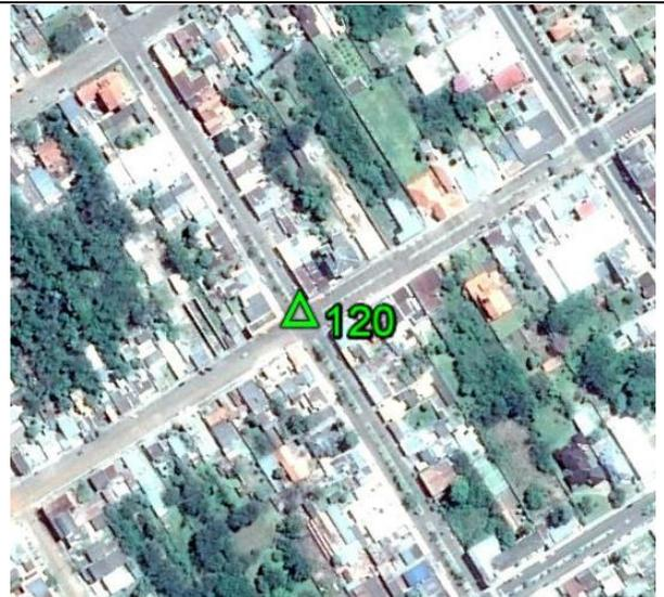
**Fecha: 07/10/2017****Modo de Levantamiento: RTK****Tipo / Modelo de antena utilizado: Trimble/ R8s Internal****Altura / Tipo de Medición de la antena: 2,000 / Base del montaje****Nombre de archivo Rinex: -****Observaciones: Punto recogido en la Avenida. Todas las unidades están en metros.****Ejecutado por:****Topocart - Topografía, Engenharia e Aerolevantamento S/S Ltda.**
