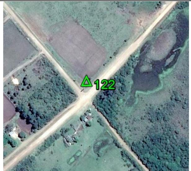
**Fecha: 07/10/2017****Modo de Levantamiento: RTK****Tipo / Modelo de antena utilizado: Trimble/ R8s Internal****Altura / Tipo de Medición de la antena: 2,000 / Base del montaje****Nombre de archivo Rinex: -****Observaciones: Punto recogido sobre el terreno. Todas las unidades están en metros.****Ejecutado por:****Topocart - Topografía, Engenharia e Aerolevanteamento S/S Ltda.**
