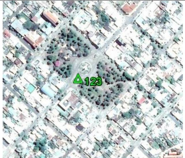
**Fecha: 07/10/2017****Modo de Levantamiento: RTK****Tipo / Modelo de antena utilizado: Trimble/ R8s Internal****Altura / Tipo de Medición de la antena: 2,000 / Base del montaje****Nombre de archivo Rinex: -****Observaciones: Punto recogido en el asfalto. Todas las unidades están en metros.****Ejecutado por:****Topocart - Topografía, Engenharia e Aerolevantamento S/S Ltda.**
