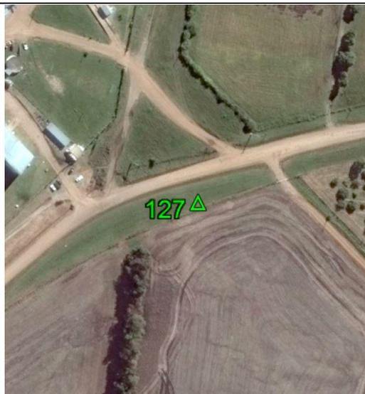
**Fecha: 07/10/2017****Modo de Levantamiento: RTK****Tipo / Modelo de antena utilizado: Trimble/ R8s Internal****Altura / Tipo de Medición de la antena: 2,000 / Base del montaje****Nombre de archivo Rinex: -****Observaciones: Punto recogido en el terreno. Todas las unidades están en metros.****Ejecutado por:****Topocart - Topografía, Engenharia e Aerolevantamento S/S Ltda.**
