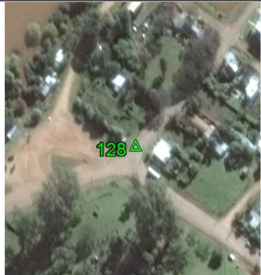
**Fecha: 07/10/2017****Modo de Levantamiento: RTK****Tipo / Modelo de antena utilizado: Trimble/ R8s Internal****Altura / Tipo de Medición de la antena: 2,000 / Base del montaje****Nombre de archivo Rinex: -****Observaciones: Punto fue recogido en el asfalto. Todas las unidades están en metros.****Ejecutado por:****Topocart - Topografía, Engenharia e Aerolevantamento S/S Ltda.**
