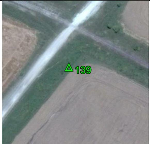
**Fecha: 08/10/2017****Modo de Levantamiento: RTK****Tipo / Modelo de antena utilizado: Trimble/ R8s Internal****Altura / Tipo de Medición de la antena: 2,000 / Base del montaje****Nombre de archivo Rinex: -****Observaciones:** Punto recogido en el terreno. Todas las unidades están en metros.**Ejecutado por:****Topocart - Topografía, Engenharia e Aerolevanteamento S/S Ltda.**
