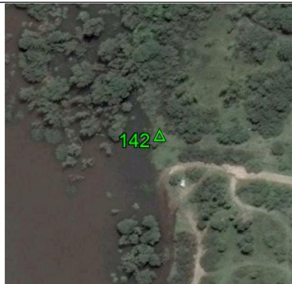
**Fecha: 02/10/2017****Modo de Levantamiento: RTK****Tipo / Modelo de antena utilizado: Trimble/ R8s Internal****Altura / Tipo de Medición de la antena: 2,000 / Base del montaje****Nombre de archivo Rinex: -****Observaciones: Punto recogido en la esquina de la calzada. Todas las unidades están en metros.****Ejecutado por:****Topocart - Topografía, Engenharia e Aerolevantamento S/S Ltda.**
