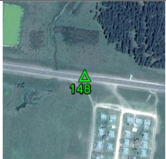
**Fecha: 02/10/2017****Modo de Levantamiento: RTK****Tipo / Modelo de antena utilizado: Trimble/ R8s Internal****Altura / Tipo de Medición de la antena: 2,000 / Base del montaje****Nombre de archivo Rinex: -****Observaciones: Punto recogido en el asfalto. Todas las unidades están en metros.****Ejecutado por:****Topocart - Topografía, Engenharia e Aerolevantamento S/S Ltda.**
