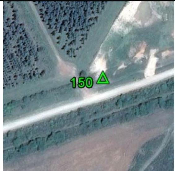
**Fecha: 02/10/2017****Modo de Levantamiento: RTK****Tipo / Modelo de antena utilizado: Trimble/ R8s Internal****Altura / Tipo de Medición de la antena: 2,000 / Base del montaje****Nombre de archivo Rinex: -****Observaciones: Punto recogido en el terreno. Todas las unidades están en metros.****Ejecutado por:****Topocart - Topografía, Engenharia e Aerolevantamento S/S Ltda.**
