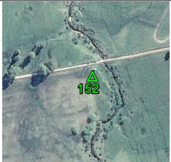
**Fecha: 02/10/2017****Modo de Levantamiento: RTK****Tipo / Modelo de antena utilizado: Trimble/ R8s Internal****Altura / Tipo de Medición de la antena: 2,000 / Base del montaje****Nombre de archivo Rinex: -****Observaciones: Punto recogido sobre el terreno. Todas las unidades están en metros.****Ejecutado por:****Topocart - Topografía, Engenharia e Aerolevanteamento S/S Ltda.**
