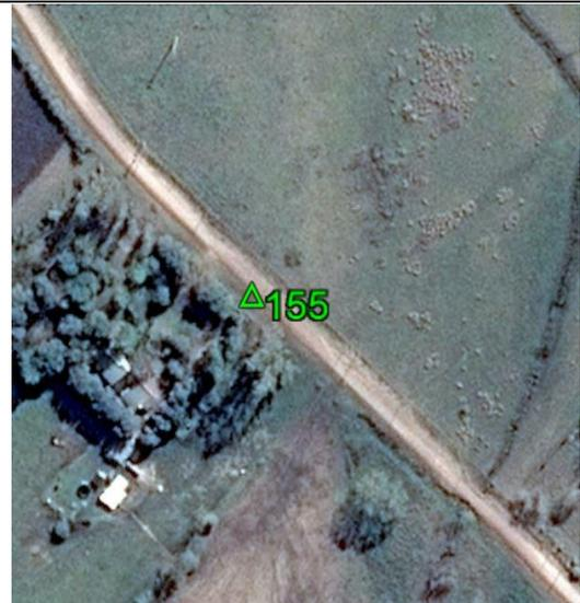
**Fecha: 02/10/2017****Modo de Levantamiento: RTK****Tipo / Modelo de antena utilizado: Trimble/ R8s Internal****Altura / Tipo de Medición de la antena: 2,000 / Base del montaje****Nombre de archivo Rinex: -****Observaciones: Punto recogido en el terreno. Todas las unidades están en metros.****Ejecutado por:****Topocart - Topografía, Engenharia e Aerolevanteamento S/S Ltda.**
