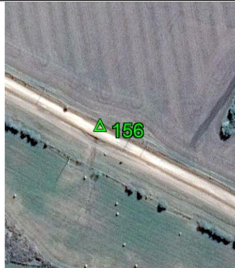
**Fecha: 02/10/2017****Modo de Levantamiento: RTK****Tipo / Modelo de antena utilizado: Trimble/ R8s Internal****Altura / Tipo de Medición de la antena: 2,000 / Base del montaje****Nombre de archivo Rinex: -****Observaciones: Punto recogido en la esquina del medio hilo. Todas las unidades están en metros.****Ejecutado por:****Topocart - Topografía, Engenharia e Aerolevantamento S/S Ltda.**
