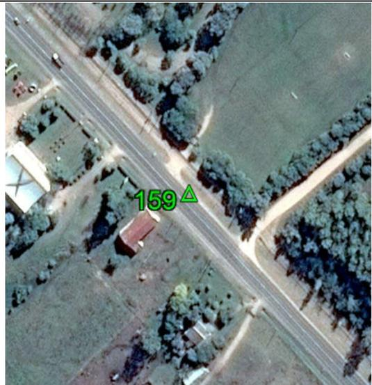
**Fecha: 02/10/2017****Modo de Levantamiento: RTK****Tipo / Modelo de antena utilizado: Trimble/ R8s Internal****Altura / Tipo de Medición de la antena: 2,000 / Base del montaje****Nombre de archivo Rinex: -****Observaciones: Punto fue recogido en el asfalto. Todas las unidades están en metros.****Ejecutado por:****Topocart - Topografía, Engenharia e Aerolevantamento S/S Ltda.**
