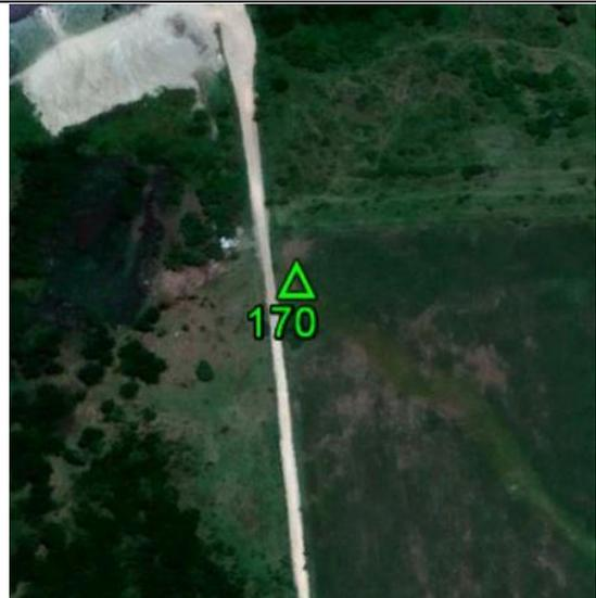
**Fecha: 21/07/2017****Modo de Levantamiento: RTK****Tipo / Modelo de antena utilizado: Trimble/ R8s Internal****Altura / Tipo de Medición de la antena: 2,000 / Base del montaje****Nombre de archivo Rinex: -****Observaciones: Punto recogido en el terreno. Todas las unidades están en metros.****Ejecutado por:****Topocart - Topografía, Engenharia e Aerolevantamento S/S Ltda.**
