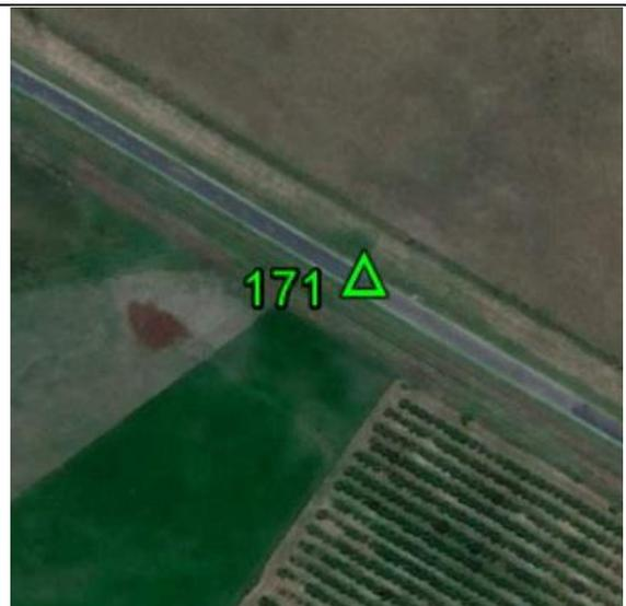
**Fecha: 21/07/2017****Modo de Levantamiento: RTK****Tipo / Modelo de antena utilizado: Trimble/ R8s Internal****Altura / Tipo de Medición de la antena: 2,000 / Base del montaje****Nombre de archivo Rinex: -****Observaciones: Punto recogido en el asfalto. Todas las unidades están en metros.****Ejecutado por:****Topocart - Topografía, Engenharia e Aerolevantamento S/S Ltda.**
