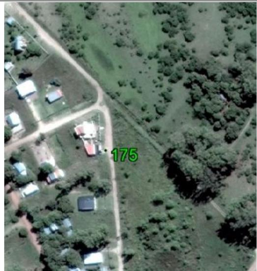
**Fecha: 26/06/2017****Modo de Levantamiento: RTK****Tipo / Modelo de antena utilizado: Trimble / R8s Internal****Altura / Tipo de Medición de la antena: 2,000 / Base del montaje****Nombre de archivo Rinex: -****Observaciones:** Punto recogido en la esquina del piso. Todas las unidades están en metros.**Ejecutado por:****Topocart - Topografía, Engenharia e Aerolevantamento S/S Ltda.**
