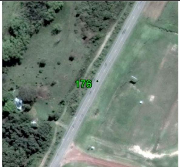
**Fecha: 26/06/2017****Modo de Levantamiento: RTK****Tipo / Modelo de antena utilizado: Trimble / R8s Internal****Altura / Tipo de Medición de la antena: 2,000 / Base del montaje****Nombre de archivo Rinex: -****Observaciones: Punto recogido en el suelo pavimentado. Todas las unidades están en metros.****Ejecutado por:****Topocart - Topografía, Engenharia e Aerolevantamento S/S Ltda.**
