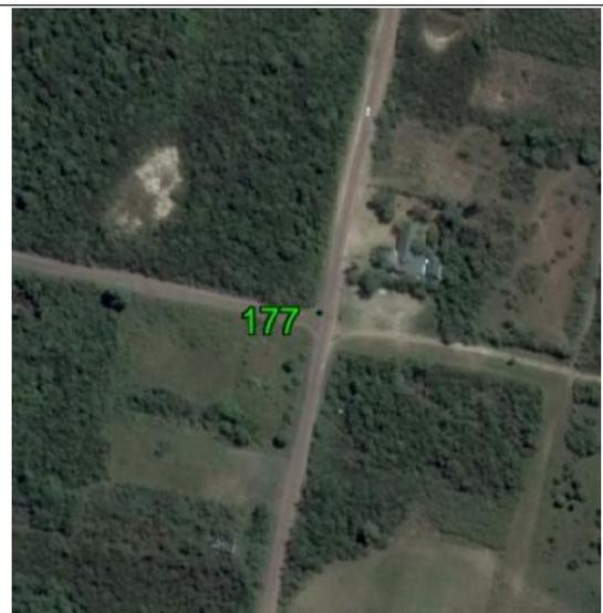
**Fecha: 26/06/2017****Modo de Levantamiento: RTK****Tipo / Modelo de antena utilizado: Trimble / R8s Internal****Altura / Tipo de Medición de la antena: 2,000 / Base del montaje****Nombre de archivo Rinex: -****Observaciones: Punto recogido en el suelo pavimentado. Todas las unidades están en metros.****Ejecutado por:****Topocart - Topografía, Engenharia e Aerolevantamento S/S Ltda.**
