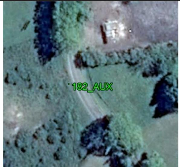
**Fecha: 31/08/2017****Modo de Levantamiento: Estático****Tipo / Modelo de antena utilizado: Trimble / R8s Internal****Altura / Tipo de Medición de la antena: 2,000 / Base del montaje****Nombre de archivo Rinex: 182\_AUX\_2433****Observaciones:** Punto recogido en la esquina de la pared. Todas las unidades están en metros.**Ejecutado por:****Topocart - Topografía, Engenharia e Aerolevantamento S/S Ltda.**
