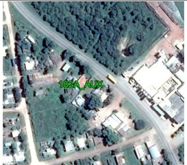
**Fecha: 31/08/2017****Modo de Levantamiento: Estático****Tipo / Modelo de antena utilizado: Trimble / R8s Internal****Altura / Tipo de Medición de la antena: 2,000 / Base del montaje****Nombre de archivo Rinex: 182A\_AUX\_2432****Observaciones: Punto recogido en el terreno. Todas las unidades están en metros.****Ejecutado por:****Topocart - Topografía, Engenharia e Aerolevantamento S/S Ltda.**
