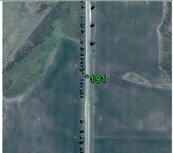
**Fecha: 20/07/2017****Modo de Levantamiento: RTK****Tipo / Modelo de antena utilizado: Trimble/ R8s Internal****Altura / Tipo de Medición de la antena: 2,000 / Base del montaje****Nombre de archivo Rinex: -****Observaciones: Punto recogido en el suelo pavimentado. Todas las unidades están en metros.****Ejecutado por:****Topocart - Topografía, Engenharia e Aerolevantamento S/S Ltda.**
