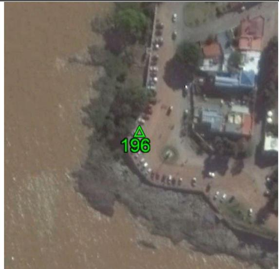
**Fecha: 04/10/2017****Modo de Levantamiento: RTK****Tipo / Modelo de antena utilizado: Trimble/ R6-4 Internal****Altura / Tipo de Medición de la antena: 2,000 / Base del montaje****Nombre de archivo Rinex: -****Observaciones: Punto recogido en la esquina de la caja de energía. Todas las unidades están en metros.****Ejecutado por:****Topocart - Topografía, Engenharia e Aerolevanteamento S/S Ltda.**
