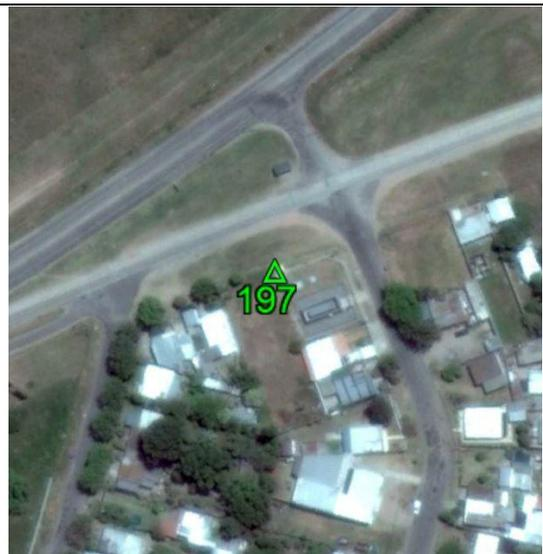
**Fecha: 04/10/2017****Modo de Levantamiento: RTK****Tipo / Modelo de antena utilizado: Trimble/ R6-4 Internal****Altura / Tipo de Medición de la antena: 2,000 / Base del montaje****Nombre de archivo Rinex: -****Observaciones: Punto recogido en la esquina de la caja de telefono. Todas las unidades están en metros.****Ejecutado por:****Topocart - Topografía, Engenharia e Aerolevanteamento S/S Ltda.**
