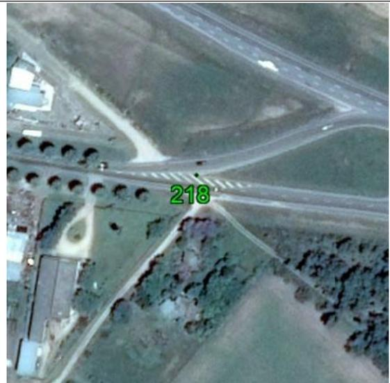
**Fecha: 28/06/2017****Modo de Levantamiento: RTK****Tipo / Modelo de antena utilizado: Trimble / R8s Internal****Altura / Tipo de Medición de la antena: 2,000 / Base del montaje****Nombre de archivo Rinex: -****Observaciones:** Punto recogido en el suelo pavimentado. Todas las unidades están en metros.**Ejecutado por:****Topocart - Topografía, Engenharia e Aerolevantamento S/S Ltda.**
