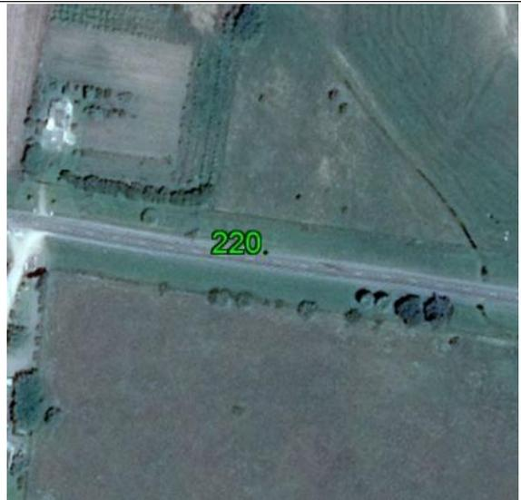
**Fecha: 04/07/2017****Modo de Levantamiento: RTK****Tipo / Modelo de antena utilizado: Trimble / R8s Internal****Altura / Tipo de Medición de la antena: 2,000 / Base del montaje****Nombre de archivo Rinex: -****Observaciones: Punto recogido en el suelo pavimentado. Todas las unidades están en metros.****Ejecutado por:****Topocart - Topografía, Engenharia e Aerolevantamento S/S Ltda.**
