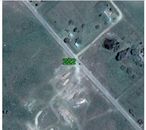
**Fecha: 27/06/2017****Modo de Levantamiento: RTK****Tipo / Modelo de antena utilizado: Trimble / R8s Internal****Altura / Tipo de Medición de la antena: 2,000 / Base del montaje****Nombre de archivo Rinex: -****Observaciones: Punto recogido en el suelo pavimentado. Todas las unidades están en metros.****Ejecutado por:****Topocart - Topografía, Engenharia e Aerolevantamento S/S Ltda.**
