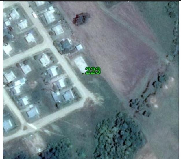
**Fecha: 27/06/2017****Modo de Levantamiento: RTK****Tipo / Modelo de antena utilizado: Trimble / R8s Internal****Altura / Tipo de Medición de la antena: 2,000 / Base del montaje****Nombre de archivo Rinex: -****Observaciones:** Punto recogido en um en el suelo concretado. Todas las unidades están en metros.**Ejecutado por:****Topocart - Topografía, Engenharia e Aerolevantamento S/S Ltda.**
