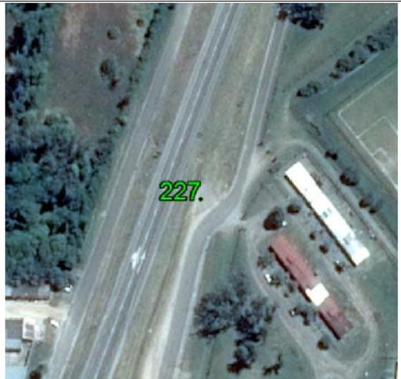
**Fecha: 28/08/2017****Modo de Levantamiento: RTK****Tipo / Modelo de antena utilizado: Trimble / R8s Internal****Altura / Tipo de Medición de la antena: 2,000 / Base del montaje****Nombre de archivo Rinex: -****Observaciones:** Punto recogido en el suelo pavimentado. Todas las unidades están en metros.**Ejecutado por:****Topocart - Topografía, Engenharia e Aerolevantamento S/S Ltda.**
