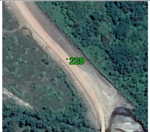
**Fecha: 28/08/2017****Modo de Levantamiento: RTK****Tipo / Modelo de antena utilizado: Trimble / R8s Internal****Altura / Tipo de Medición de la antena: 2,000 / Base del montaje****Nombre de archivo Rinex: -****Observaciones:** Punto recogido en una base de hormigón sumergido. Todas as unidades están e metros.**Ejecutado por:****Topocart - Topografia, Engenharia e Aerolevanteamento S/S Ltda.**
