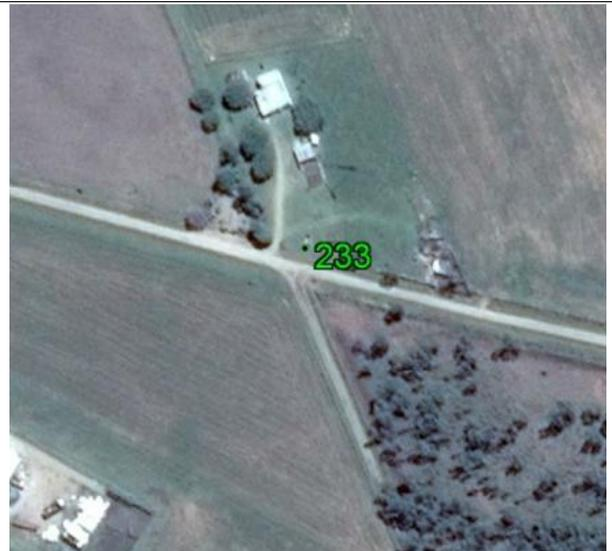
**Fecha: 28/08/2017****Modo de Levantamiento: RTK****Tipo / Modelo de antena utilizado: Trimble / R8s Internal****Altura / Tipo de Medición de la antena: 2,000 / Base del montaje****Nombre de archivo Rinex: -****Observaciones:** Punto recogido en la esquina de la pared. Todas las unidades están en metros.**Ejecutado por:****Topocart - Topografía, Engenharia e Aerolevantamento S/S Ltda.**
