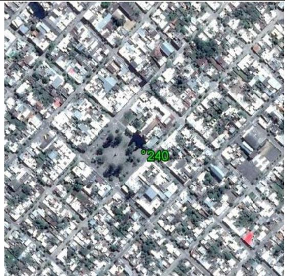
**Fecha: 24/06/2017****Modo de Levantamiento: RTK****Tipo / Modelo de antena utilizado: Trimble/ R8s Internal****Altura / Tipo de Medición de la antena: 2,000 / Base del montaje****Nombre de archivo Rinex: -****Observaciones:** Punto recogido en el suelo pavimentado. Todas las unidades están en metros.**Ejecutado por:****Topocart - Topografía, Engenharia e Aerolevantamento S/S Ltda.**
