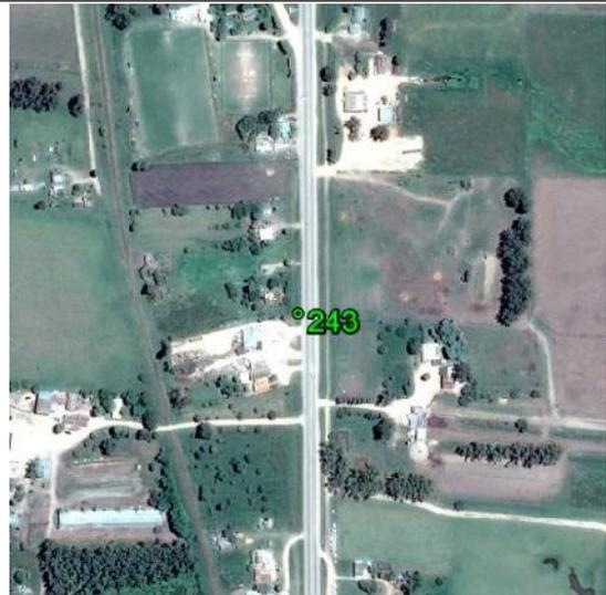
**Fecha: 24/06/2017****Modo de Levantamiento: RTK****Tipo / Modelo de antena utilizado: Trimble/ R8s Internal****Altura / Tipo de Medición de la antena: 2,000 / Base del montaje****Nombre de archivo Rinex: -****Observaciones: Punto recogido en el suelo pavimentado. Todas las unidades están en metros.****Ejecutado por:****Topocart - Topografía, Engenharia e Aerolevantamento S/S Ltda.**
