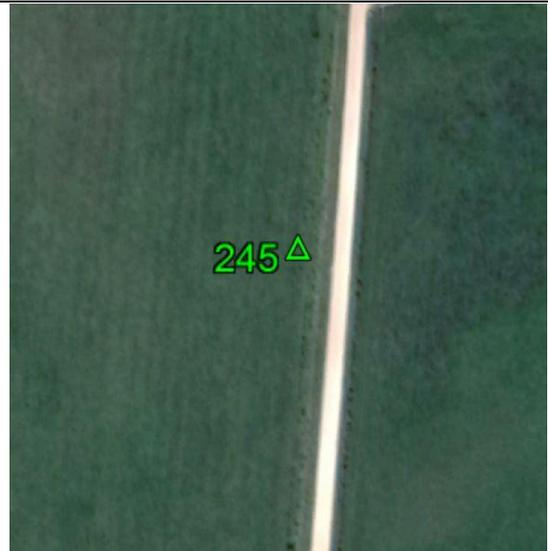
**Fecha: 20/07/2017****Modo de Levantamiento: RTK****Tipo / Modelo de antena utilizado: Trimble/ R8s Internal****Altura / Tipo de Medición de la antena: 2,000 / Base del montaje****Nombre de archivo Rinex: -****Observaciones: Punto recogido en el terreno. Todas las unidades están en metros.****Ejecutado por:****Topocart - Topografía, Engenharia e Aerolevanteamento S/S Ltda.**
