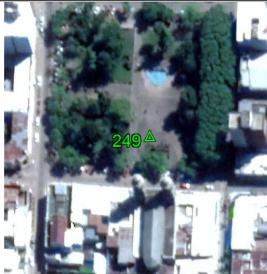
**Fecha: 20/07/2017****Modo de Levantamiento: RTK****Tipo / Modelo de antena utilizado: Trimble/ R8s Internal****Altura / Tipo de Medición de la antena: 2,000 / Base del montaje****Nombre de archivo Rinex: -****Observaciones: Punto recogido en la acera. Todas las unidades están en metros.****Ejecutado por:****Topocart - Topografía, Engenharia e Aerolevanteamento S/S Ltda.**
