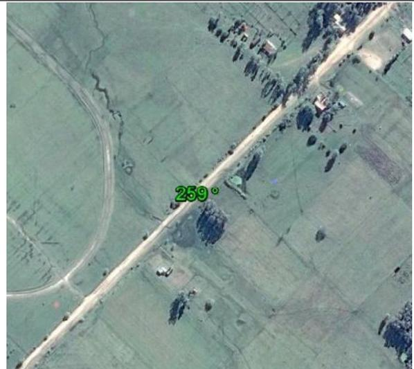
**Fecha: 20/07/2017****Modo de Levantamiento: RTK****Tipo / Modelo de antena utilizado: Trimble/ R8s Internal****Altura / Tipo de Medición de la antena: 2,000 / Base del montaje****Nombre de archivo Rinex: -****Observaciones: Punto recogido en el terreno. Todas las unidades están en metros.****Ejecutado por:****Topocart - Topografía, Engenharia e Aerolevantamento S/S Ltda.**
