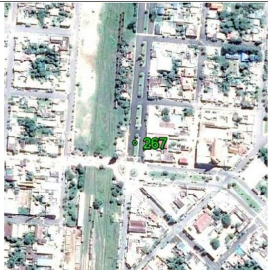
**Fecha: 24/06/2017****Modo de Levantamiento: RTK****Tipo / Modelo de antena utilizado: Trimble/ R8s Internal****Altura / Tipo de Medición de la antena: 2,000 / Base del montaje****Nombre de archivo Rinex: -****Observaciones: Punto recogido en una base de hormigón. Todas as unidades estão e metros.****Ejecutado por:****Topocart - Topografia, Engenharia e Aerolevantamento S/S Ltda.**
