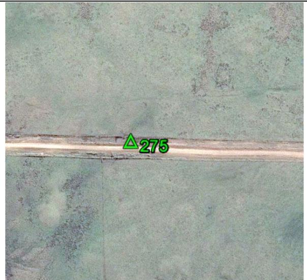
**Fecha: 06/10/2017****Modo de Levantamiento: RTK****Tipo / Modelo de antena utilizado: Trimble/ R8s Internal****Altura / Tipo de Medición de la antena: 2,000 / Base del montaje****Nombre de archivo Rinex: -****Observaciones: Punto fue recogido en el terreno. Todas las unidades están en metros.****Ejecutado por:****Topocart - Topografía, Engenharia e Aerolevantamento S/S Ltda.**
