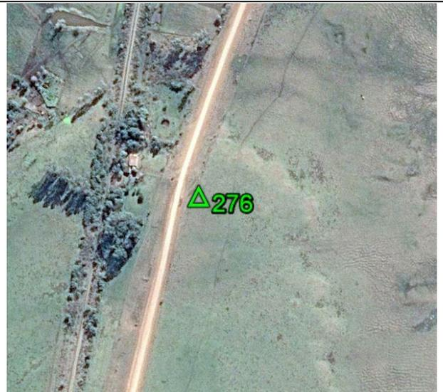
**Fecha: 06/10/2017****Modo de Levantamiento: RTK****Tipo / Modelo de antena utilizado: Trimble/ R8s Internal****Altura / Tipo de Medición de la antena: 2,000 / Base del montaje****Nombre de archivo Rinex: -****Observaciones: Punto recogido sobre el terreno. Todas las unidades están en metros.****Ejecutado por:****Topocart - Topografía, Engenharia e Aerolevanteamento S/S Ltda.**
