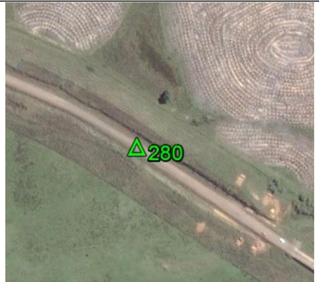
**Fecha: 06/10/2017****Modo de Levantamiento: RTK****Tipo / Modelo de antena utilizado: Trimble/ R8s Internal****Altura / Tipo de Medición de la antena: 2,000 / Base del montaje****Nombre de archivo Rinex: -****Observaciones: Punto recogido en el asfalto. Todas las unidades están en metros.****Ejecutado por:****Topocart - Topografía, Engenharia e Aerolevantamento S/S Ltda.**
