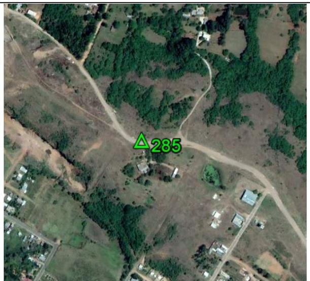
**Fecha: 06/10/2017****Modo de Levantamiento: RTK****Tipo / Modelo de antena utilizado: Trimble/ R8s Internal****Altura / Tipo de Medición de la antena: 2,000 / Base del montaje****Nombre de archivo Rinex: -****Observaciones: Punto recogido sobre el terreno. Todas las unidades están en metros.****Ejecutado por:****Topocart - Topografía, Engenharia e Aerolevantamento S/S Ltda.**
