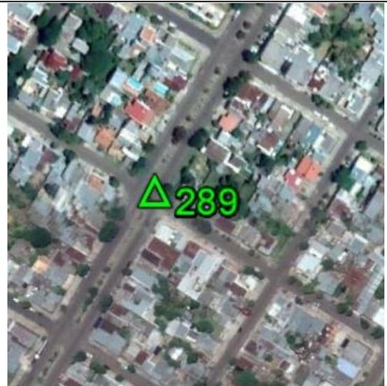
**Fecha: 06/10/2017****Modo de Levantamiento: RTK****Tipo / Modelo de antena utilizado: Trimble/ R8s Internal****Altura / Tipo de Medición de la antena: 2,000 / Base del montaje****Nombre de archivo Rinex: -****Observaciones: Punto recogido en el asfalto. Todas las unidades están en metros.****Ejecutado por:****Topocart - Topografía, Engenharia e Aerolevantamento S/S Ltda.**
