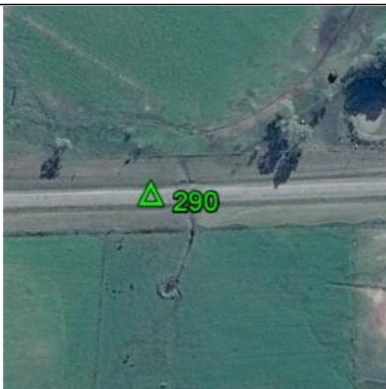
**Fecha: 04/10/2017****Modo de Levantamiento: RTK****Tipo / Modelo de antena utilizado: Trimble/ R8s Internal****Altura / Tipo de Medición de la antena: 2,000 / Base del montaje****Nombre de archivo Rinex: -****Observaciones: Punto recogido en el asfalto. Todas las unidades están en metros.****Ejecutado por:****Topocart - Topografía, Engenharia e Aerolevanteamento S/S Ltda.**
